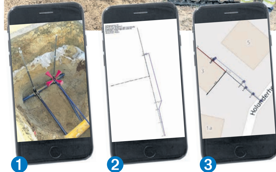
Tobias Lindhorst hat den Hausanschluss fertig und erfasst nun mit dem Smartphone und App sämtliche Daten.
