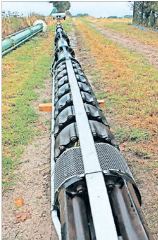
Ein seltener Anblick – Pumpe mit Steigrohr der Länge nach.
