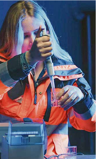
Mit einem Fotometer werden die Eisen- und Manganwerte überprüft.
