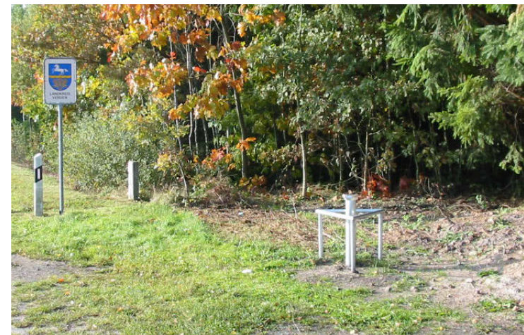
An über 400 Messstellen wird der Grundwasserspiegel regelmäßig geprüft
